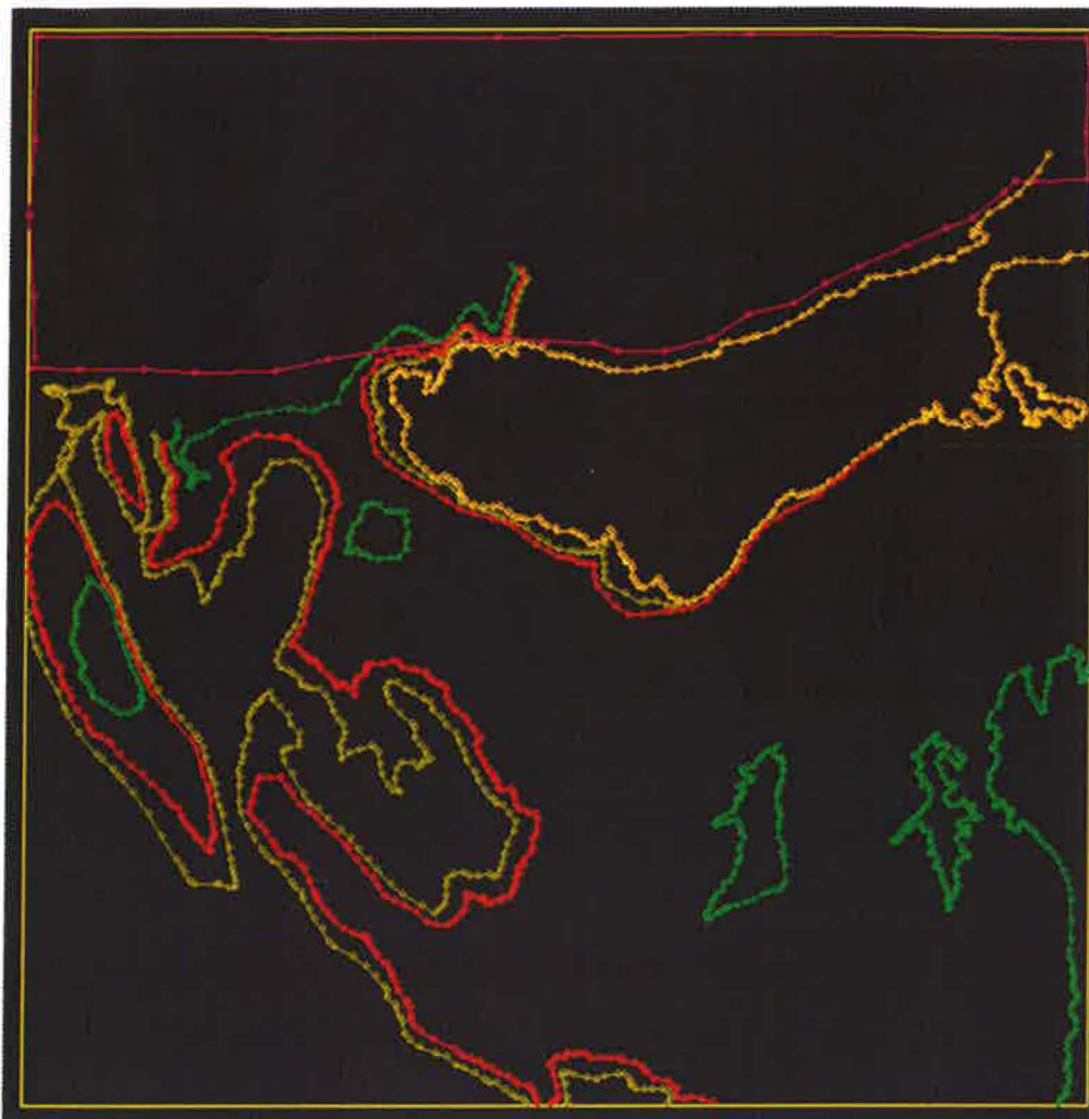
Figura 26: Sección superficial con contactos entre las formaciones geológicas que afloran en superficie. En la parte superior se impone un límite de tipo erosivo (Erode) a través de un Intrusivo ficticio que corta todas las formaciones para evitar errores y desviaciones en la modelización.
