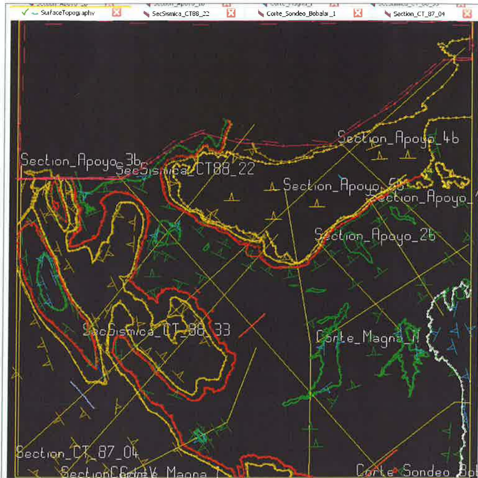
Figura 42: Sección superficial con datos estructurales importados y trazas de secciones verticales. El modelo 3D ya ha sido calculado y superpuesto a los contactos cartográficos digitalizados. En la parte superior se impone un límite de tipo erosivo (Erode) a través de un Intrusivo que corta todas las series/formaciones para evitar errores y desviaciones en la modelización por encontrarse la zona norte sin datos.
